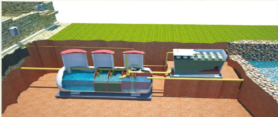
Hình 3.4. Sơ đồ cấu tạo bể Bastafat
